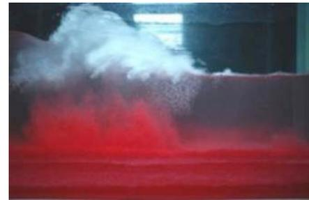
Photo montrant la remise en suspension engendrée par le déferlement d'une vague (canal à houle du LEGI)
