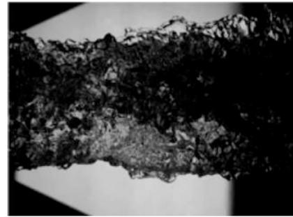
*Vue en imagerie rapide des instabilités d'interface d'un jet plongeant (avant impact avec la surface libre en aval).*
