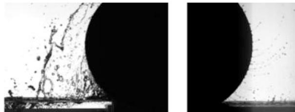
Mécanismes d'éclaboussures par une roue tournante, avec (à gauche) formation d'un ménisque dynamique et (à droite) apparition de filaments (instabilité de Rayleigh-Taylor) se fragmentant en gouttelettes (instabilité de Rayleigh-Plateau).
