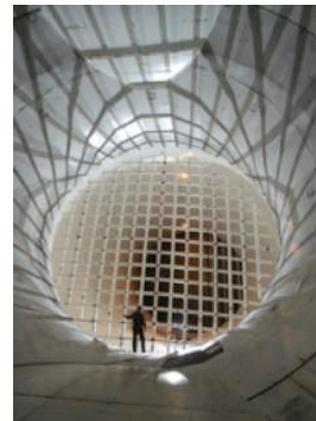
*Vue depuis la veine d'essai de la grille génératrice de turbulence dans la grande soufflerie S1MA de l'ONERA lors de l'essai de mars 2014.*
