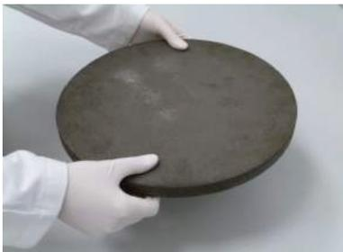
*L'incorporation de Graphite naturel expansé (GNE) permet une augmentation sensible de la conductivité thermique du matériau de stockage : (a) vue au microscope des feuillets de GNE après compression uniaxiale ; (b) réalisation de disques d'hydrure de magnésium dia. 200 mm*
