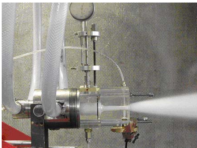
Figure : Tuyère instrumentée et placée, pour mesure et visualisation, sur le banc insonorisé du LEGI.
