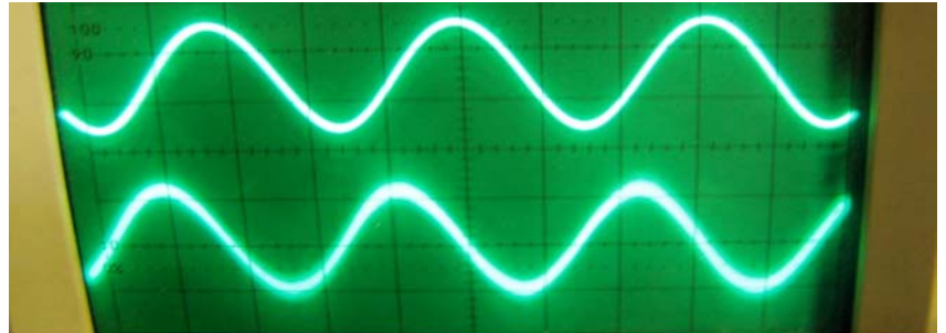
Figure 4. l'expérience thermoacoustique MHD réalisée dans le cadre du projet financé par l'ESA et vue d'écran des signaux de pression et de potentiel électrique issus de l'expérience.
