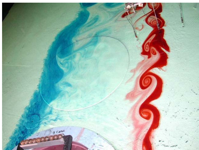
Sillage derrière un obstacle circulaire ( \varnothing 1m) dans une couche stratifiée tournante. La différence d'organisation entre la zone cyclonique (droite) et la zone anticyclonique (gauche) est bien visible
