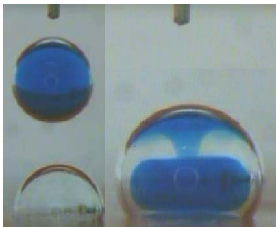
Figure 4b : Les principales étapes de l'encapsulation : (1) goutte «volante» (2) état initial du mélange: la structure «champignon»
